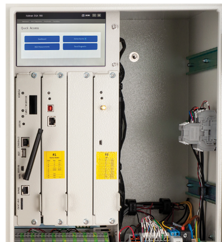
Ubicación de un máximo de 3 tarjetas adicionales
